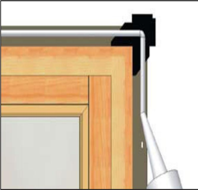
Aplica una capa de sellante de 3/8" de diámetro continuamente a lo largo del lado posterior de la aleta clavada. El sellante debe correr continuamente alrededor de los dos lados y cubriendo la cabecera, en línea y cubriendo completamente los huecos de la aleta clavada.
